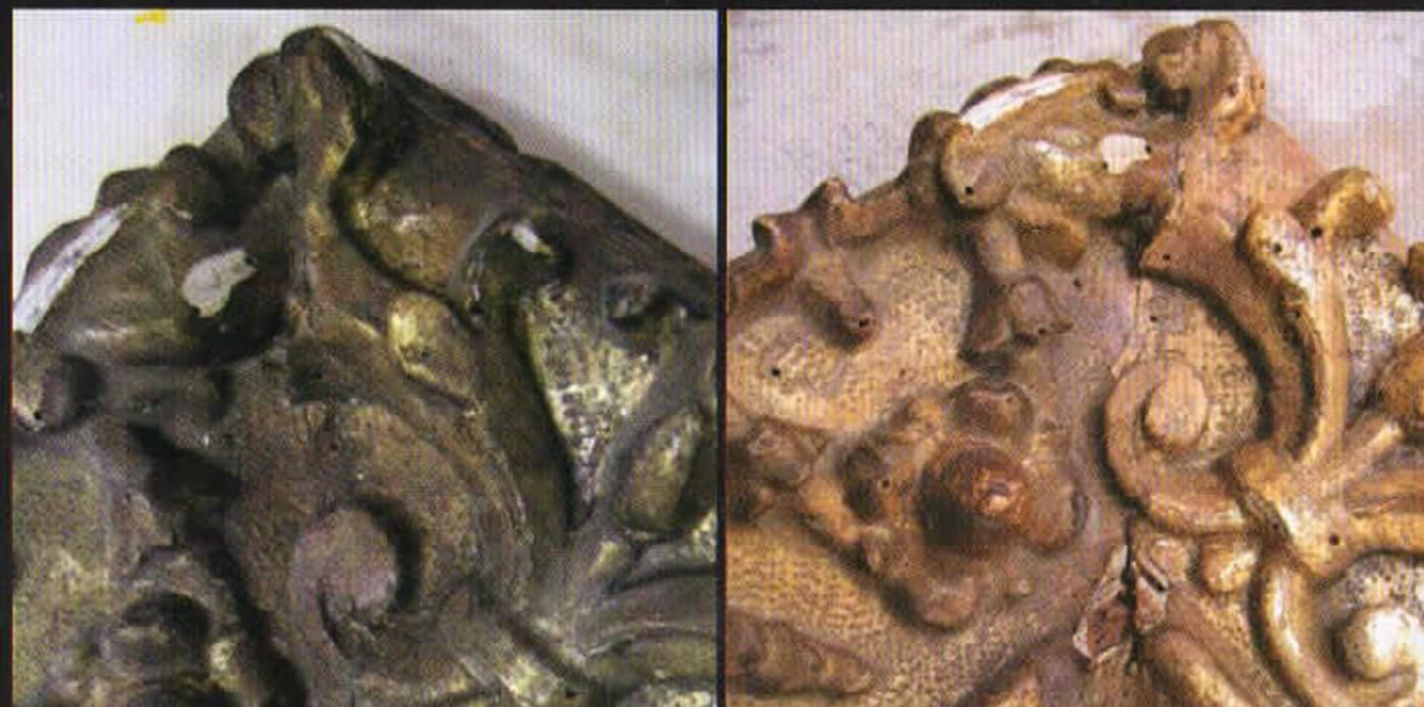
Pulitura Laser di cornice lignea
