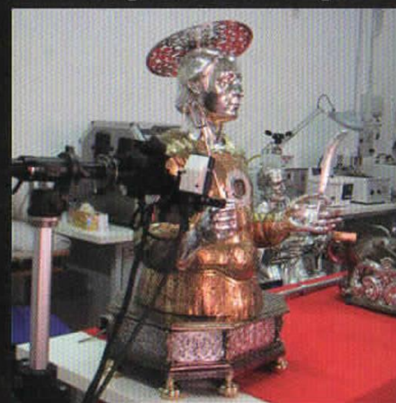
Analisi XRF del busto in argento di S. Sergio
